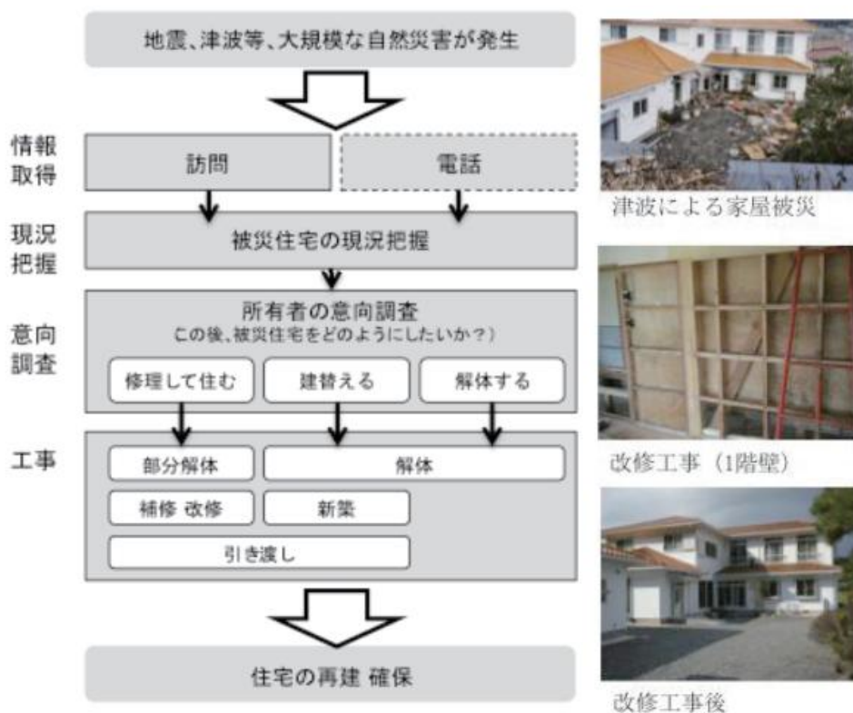
図 被災家屋の補修・改修のフロー
